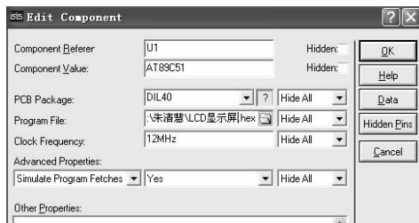
图 4 Proteus ISIS 中单片机程序的导入 Fig. 4 Import of MCU program in proteus ISIS
